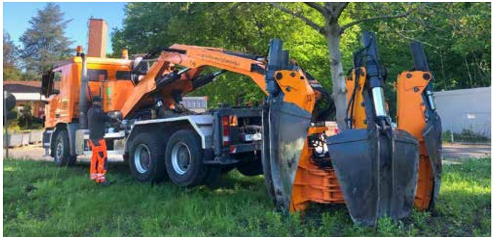
SCHRITT 1: Der Baum wird mitsamt seiner Wurzel aus dem Erdreich gehoben.
