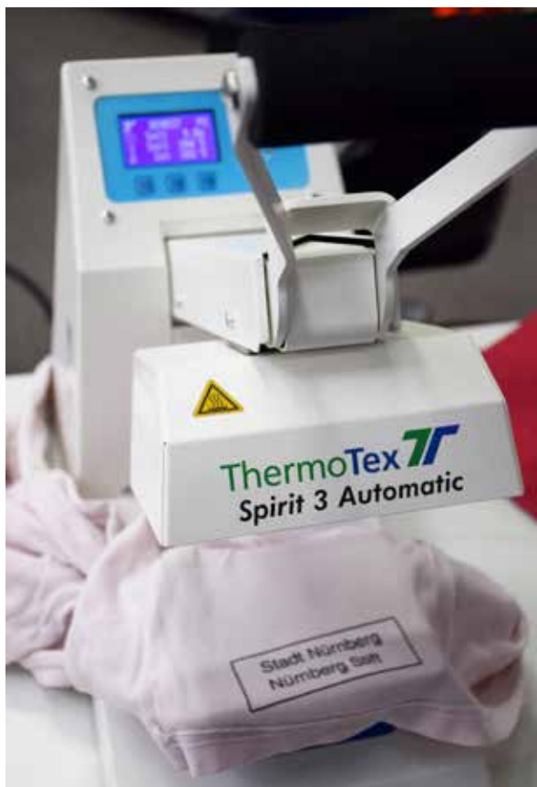
WERKZEUG: Mit dieser Maschine werden die Schriftzüge aufgebracht.
